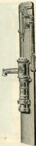
Pour rendre ces pompes INCONGELABLES, il suffit de lever le balancier jusqu'au bout de sa course pendant le temps nécessaire pour vider le corps de pompe ; quelques coups de balancier suffisent pour faire revenir l'eau lorsque l'on veut pomper à nouveau.
